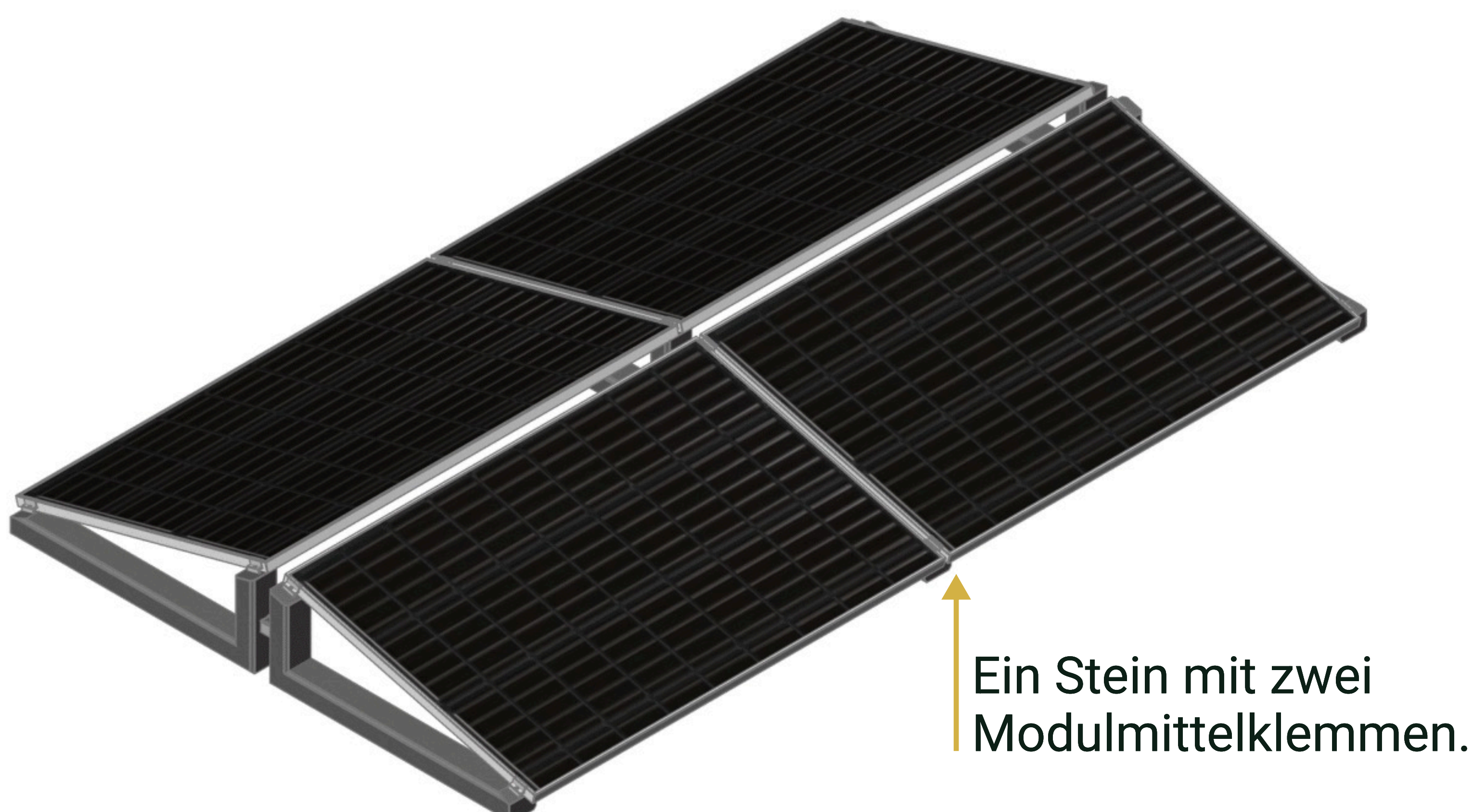
Schematischer Aufbau Wattstone 15° Ost-West mit Verbindungsset. 4 St. Module bei 1,8 kWp mit 6 St. Wattstone 15°, 3 Ost-West Verbindungssets.
